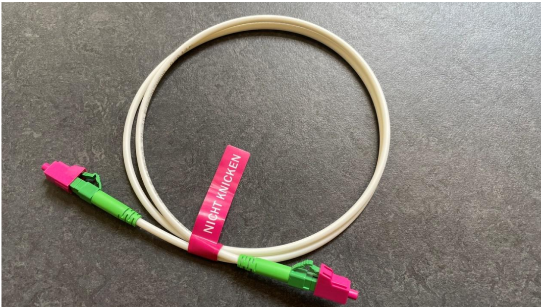
Abbildung 26: Glasfaser-Verbindungskabel mit LC-APC Steckern und magentafarbener Schutzkappe (Quelle: DT)
