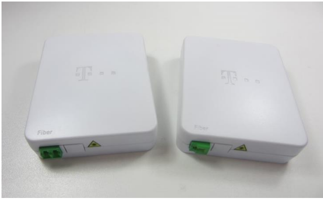
Abbildung 45: Gf-TA – links 2 Ausgänge auf LC-APC, rechts 1 Ausgang auf LC-APC (Quelle: Fa. Omelcom)
