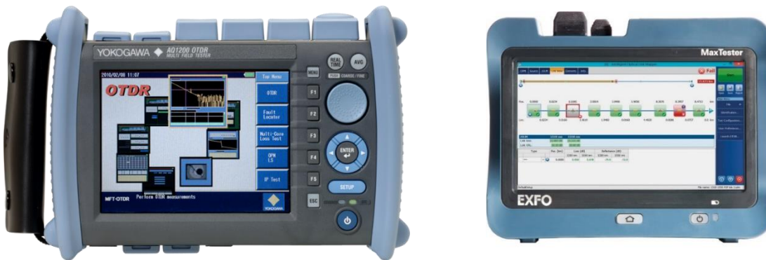
Abbildung 58: Beispiele von OTDR's für NE4 (Quellen: links: Fa. Yokogawa; rechts: Fa. 3 Edge / Fa. EXFO)
