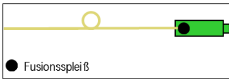
Abbildung 37: Prinzipdarstellung zur Konfektionierung eines „Spleißsteckers“ an ein Kabelende (Quelle: DT)
