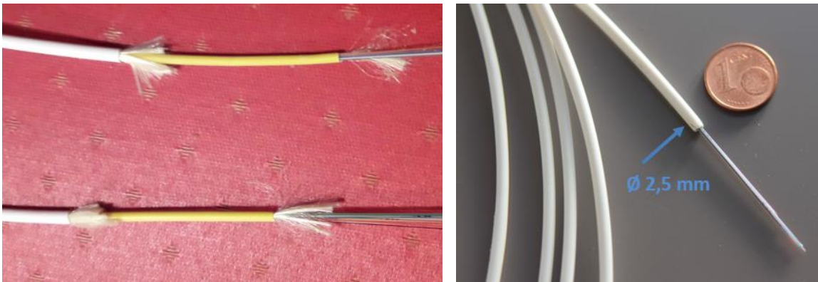
Abbildung 25: Darstellung eines Gf-Innen-Mikrokabels zum Einblasen; Ø 2,5 mm (Quelle: DT)
