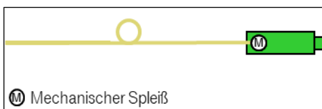
Abbildung 39: Prinzipdarstellung eines Steckers mit integriertem mechanischem Spleiß (Quelle: DT)
